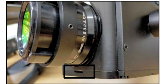
SDカードの挿入口
