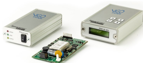
VIGO System社製 TECコントローラ (左からbasic/OEM/advancedモデル)
